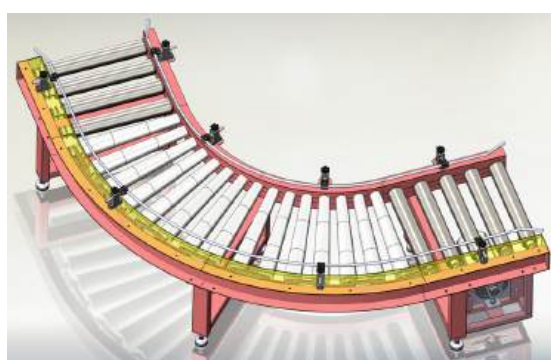
Giàn con lăn xích cong, con lăn côn vỏ nhựa, tải trọng nhẹ
