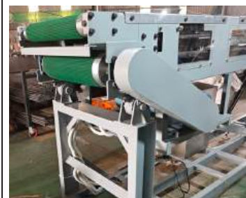
Băng tải nâng hạ cơ rút (băng tải telescopic)
