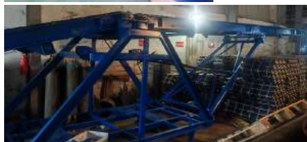
Băng tải nâng hạ cơ rút (băng tải telescopic)
